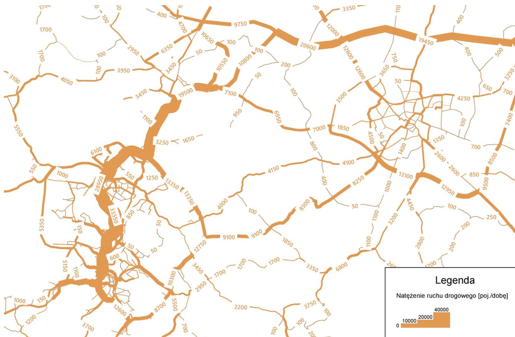
Rys. 41 Rozkład natężenia ruchu drogowego w dobie, scenariusz ograniczonej współpracy – rok 2035, obszar Wałbrzycha i Świdnicy
