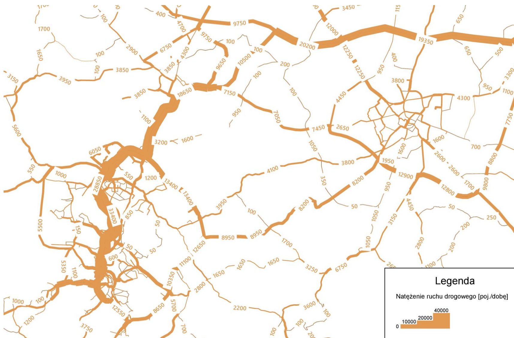
Rys. 24 Rozkład natężenia ruchu drogowego w dobie, scenariusz referencyjny – rok 2035, obszar Wałbrzycha i Świdnicy
